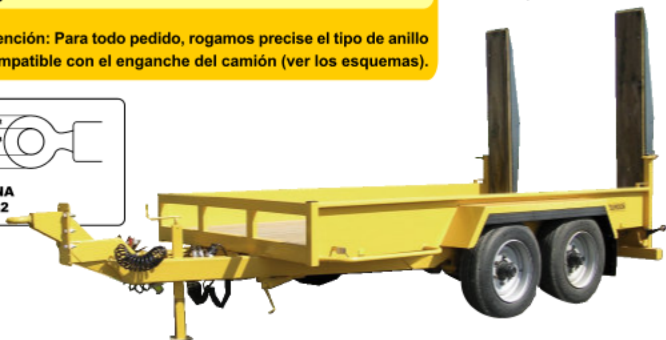
Rampas regulables en altura, asistidas por muelles
