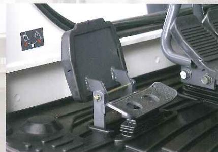
Pisar el lado derecho o izquierdo del pedal para alargar o doblar el brazo principal.
