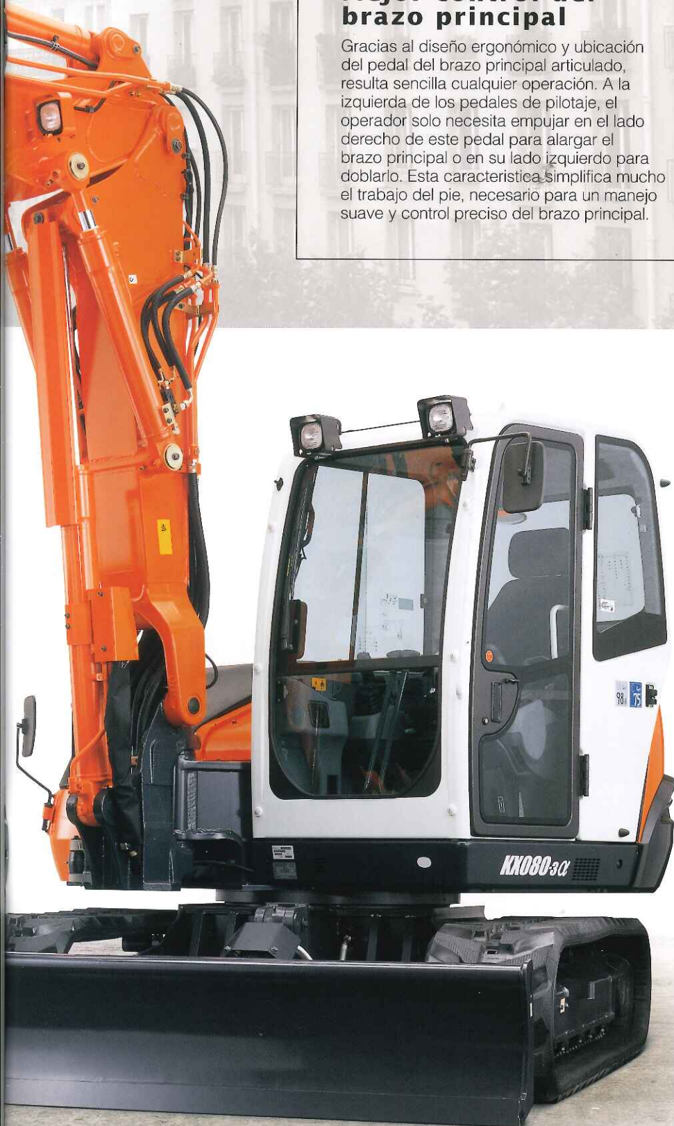
Pisar el lado derecho o izquierdo del pedal para alargar o doblar el brazo principal.
