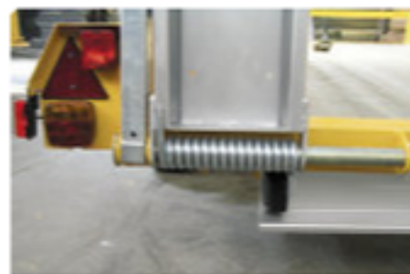
Rampas regulables en separación, con ayuda de muelles con pie automático
